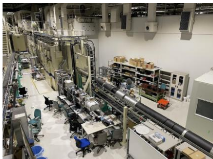
蓄積リング棟内実験ハッチと中尺BL実験施設へつながる真空パイプ
