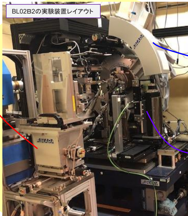
実験ハッチ内の半導体検出器多連装型粉末回折計
