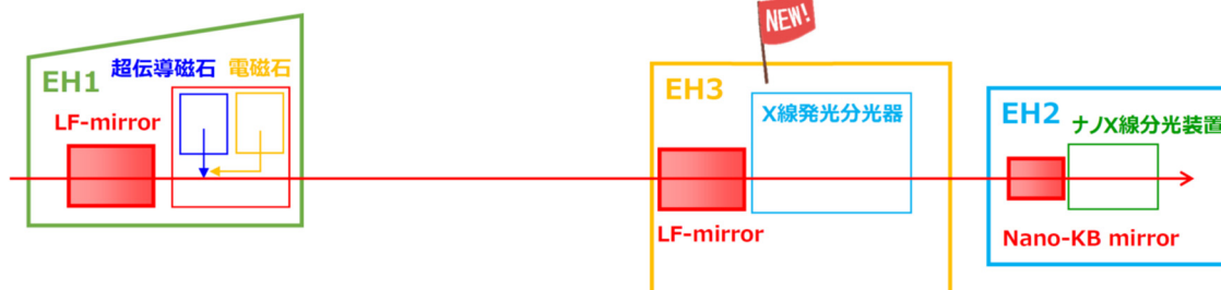
図 1. BL39XU のビームライン改造計画の概略図。
